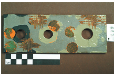
Ausflecksarbeiten im Test: Gitterschnittprüfung und Haftzugfestigkeitsmessung.
